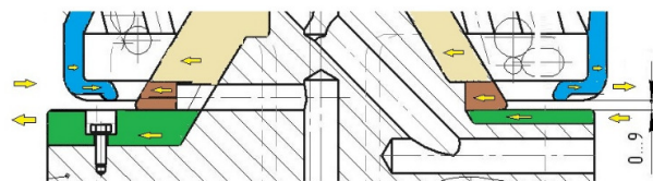
Рис.2. eNPCS вид разгрузочной щели в разрезе в эксцентриковой позиции
